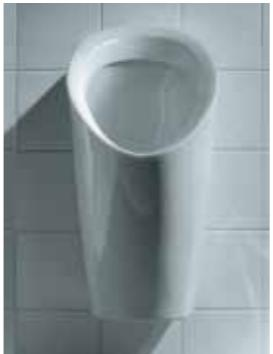
Писсуар LAUFEN lema «0 литров» экономит воду и деньги. Он функционирует без воды и не требует устройства ограничения водопритока или электричества для перекрытия водоотвода. Писсуар самостоятельно обеспечивает изоляцию испарений и предупреждает их выпуск. Принцип устройства этой «ловушки» известен в химической индустрии как колба Эрленмейера.
