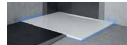
**Вкладка для установки LAUFEN** из твердого пенистого материала позволяет установить поддон для душевой кабины бровень с полом и при этом сохранить его тепло- и звукоизоляцию. Внешний защитный слой вкладки в перспективе будет предотвращать проникновение воды между кафелем и поддоном.
