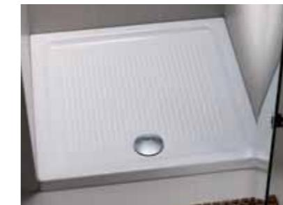
Противоскользящее покрытие наносится на поверхность перед нанесением глазури или эмали, а потом подвергается обжигу для того, чтобы окончательно соединиться со структурой поверхности. Покрытие обеспечивает защиту от скольжения, и оно также легко чистится, устойчиво к кислотам и механическим повреждениям. Слой, препятствующий скольжению, проверен в соответствии с нормами немецкой промышленности DIN 51097: он обладает повышенной сопротивляемостью к скольжению.
